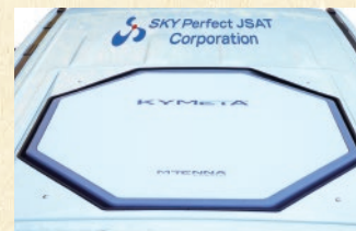
平面アンテナ(自動車の屋根に設置)
